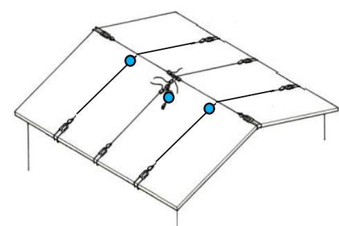
軒先の高さが低い建物や安全ブロックの取付位置から地上までの距離が短い場合などは、ストラップの短い安全ブロックを使用するか、安全ブロックを取り付ける位置をよく検討する必要があります。
